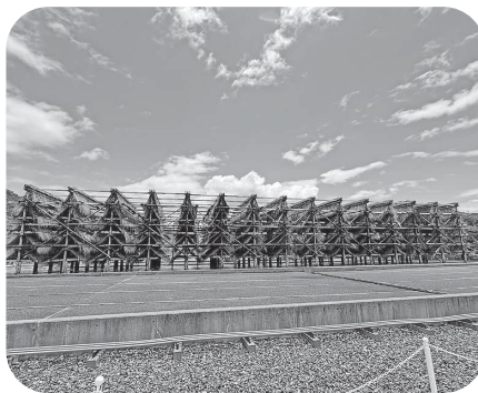
流下式枝条架併用塩田
