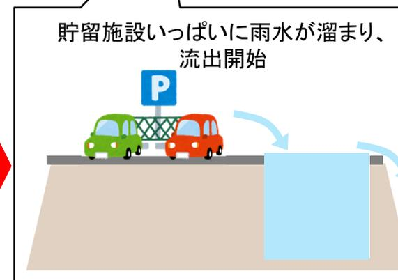
1,000m<sup>2</sup>を舗装すると、ピーク流出量が0.003m<sup>3</sup>/sから0.012m<sup>3</sup>/s(p9参照)に増加します。ピーク流出量を0.003m<sup>3</sup>/sに抑えるためには、上記緑着色部すべてを貯留する必要があり、その容量は395m<sup>3</sup>です。
