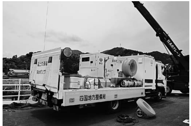
排水ポンプ車(電源車)
